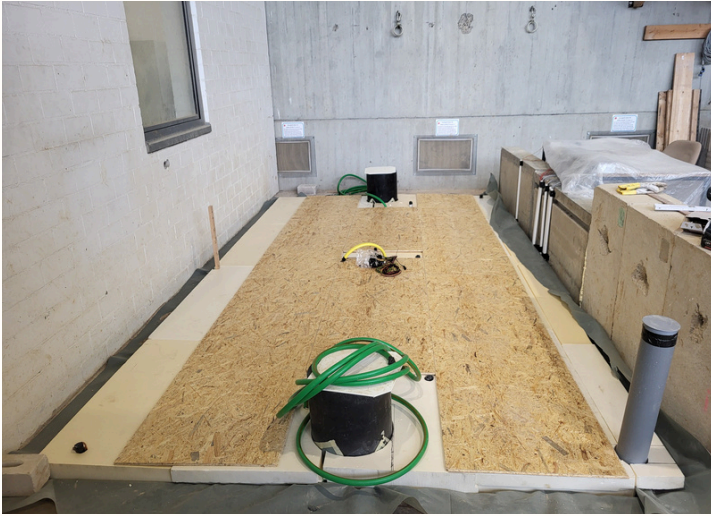
Reallabor II: Versuchsstand am Institut für Geotechnik der Universität Stuttgart mit Einbau des messtechnisch ausgestatteten Hybridkanals. @Till Kugler
