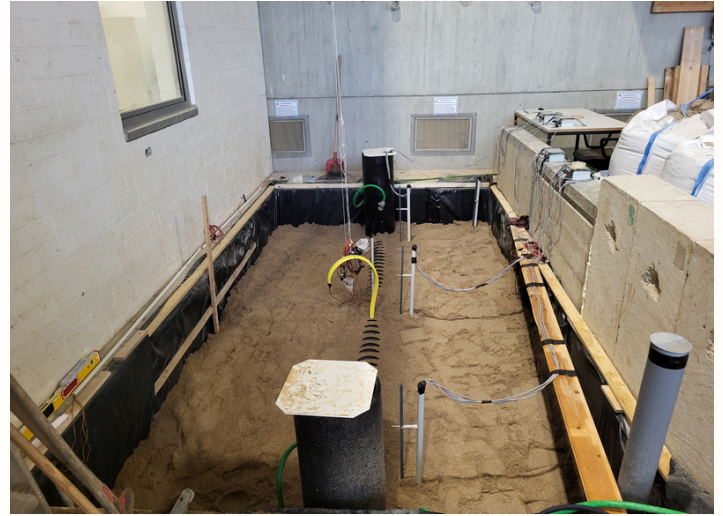
Reallabor II: Versuchsstand am Institut für Geotechnik der Universität Stuttgart mit Einbau des messtechnisch ausgestatteten Hybridkanals. @Till Kugler
