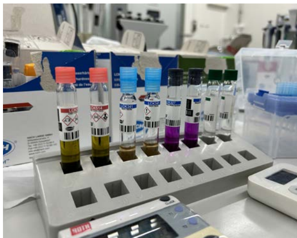
Bestimmung der Parameter CSB, Nitrit, Wasserhärte und Nitrat im Rohgrauwasser mittels Küvettentests.
