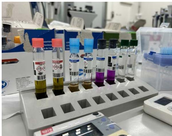
Bestimmung der Parameter CSB, Nitrit, Wasserhärte und Nitrat im Rohgrauwasser mittels Küvettentests.
