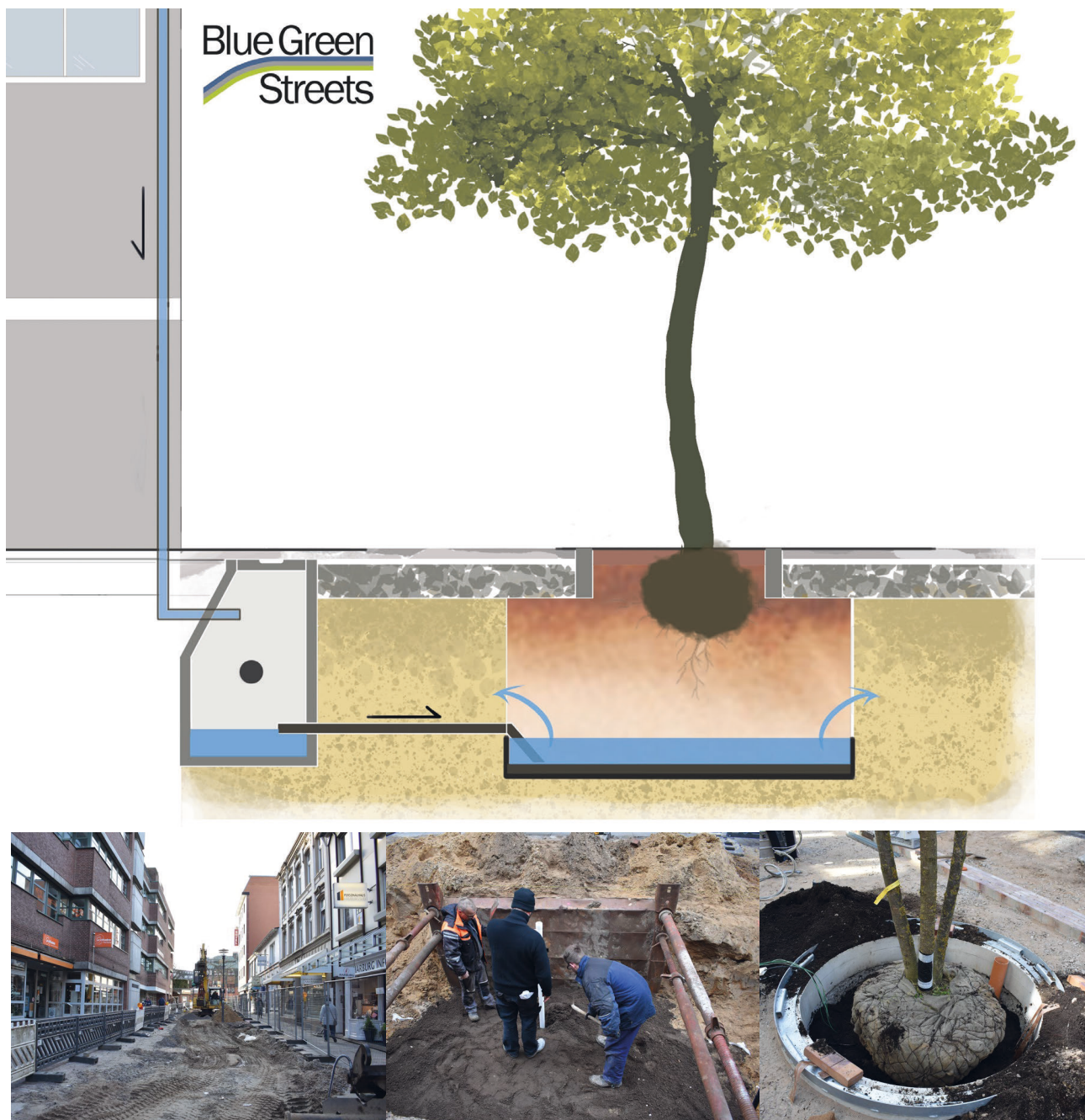
Abbildung 9 Schematischer Aufbau der Pflanzgrube in der Hölertwiete in Hamburg-Harburg (oben) sowie Eindrücke von der Baustelle (unten), Quelle: BGS, Fotos: Michael Richter.
