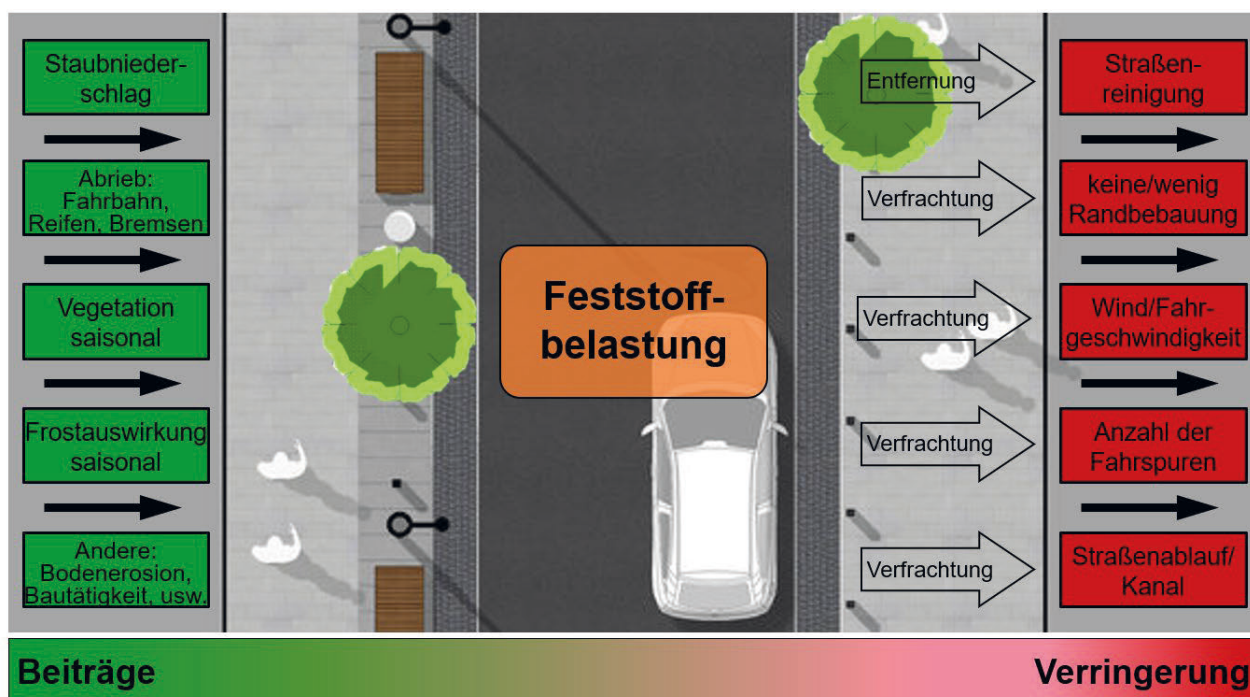
Abbildung 19 Einflussfaktoren der Feststoffbelastung im Straßenraum, Quelle: BGS, TU Berlin basierend auf Welker und Dierschke (2013).
