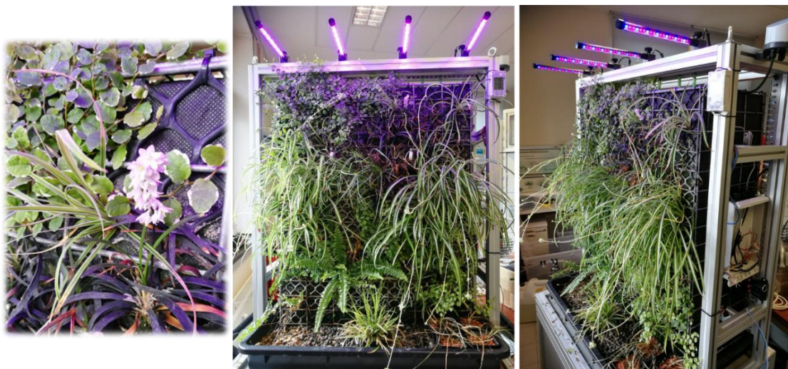
Abbildung 19: Funktionsmuster eines Pflanzen-Klär-Moduls im Labor des ifak.
