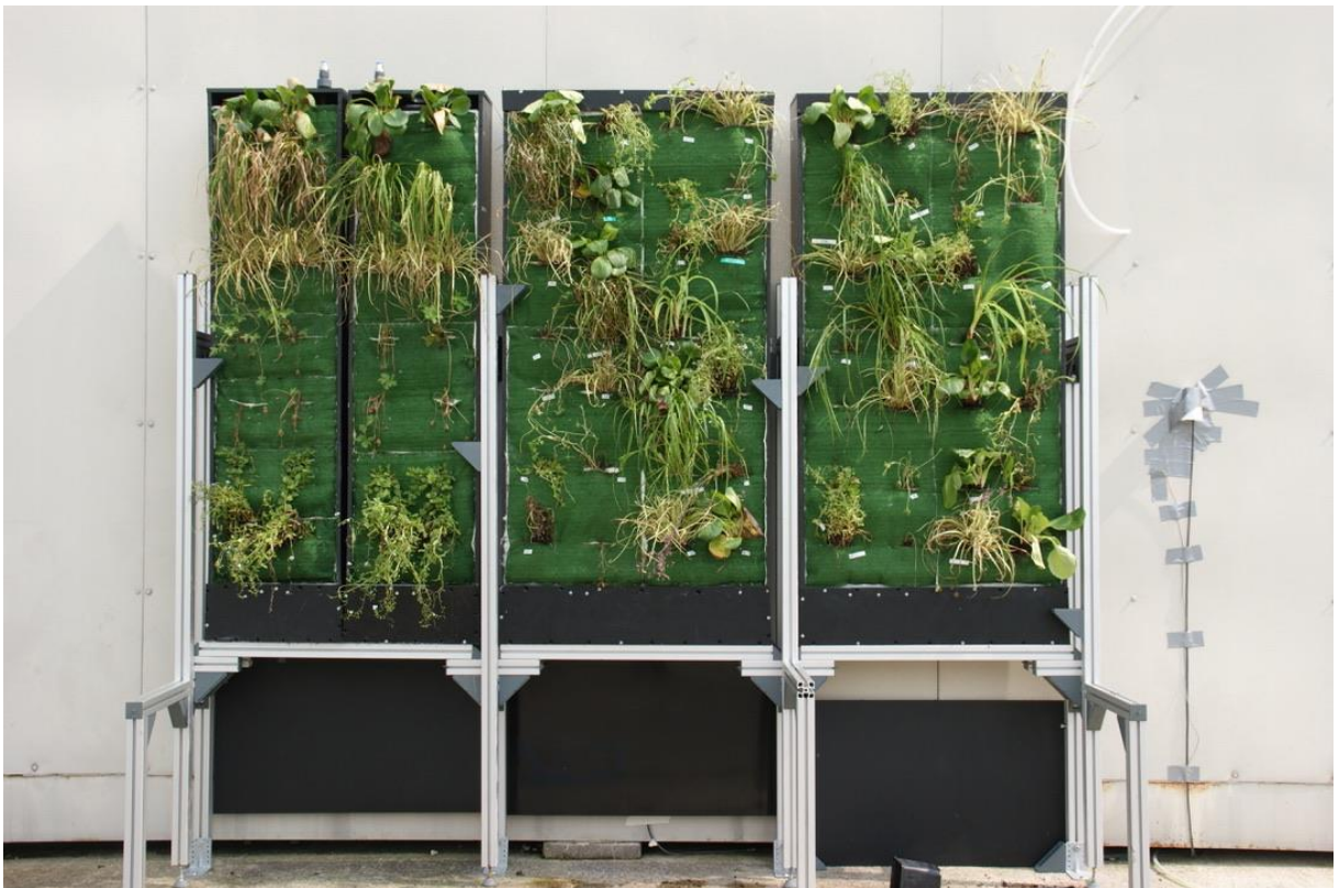
Abbildung 8: VertiKKA-Module kurz nach der Bepflanzung (ohne Zulauf- und Ablauf-Peripherie). Links jeweils die 40 cm Module und im mittleren und rechten Segment die 80 cm Module (Foto Aicher).
