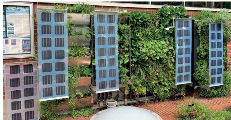
Abbildung: Versuchsaufbau der VertiKKA an der HfWU in Nürtingen mit unterschiedlichen Begrünungssystemen und vorgehängten Photovoltaikmodulen zur Untersuchung der Pflanzenvitalität über die Vegetationsperiode und der Interaktion Pflanze und Photovoltaikmodul (Bild: HfWU Nürtingen)
