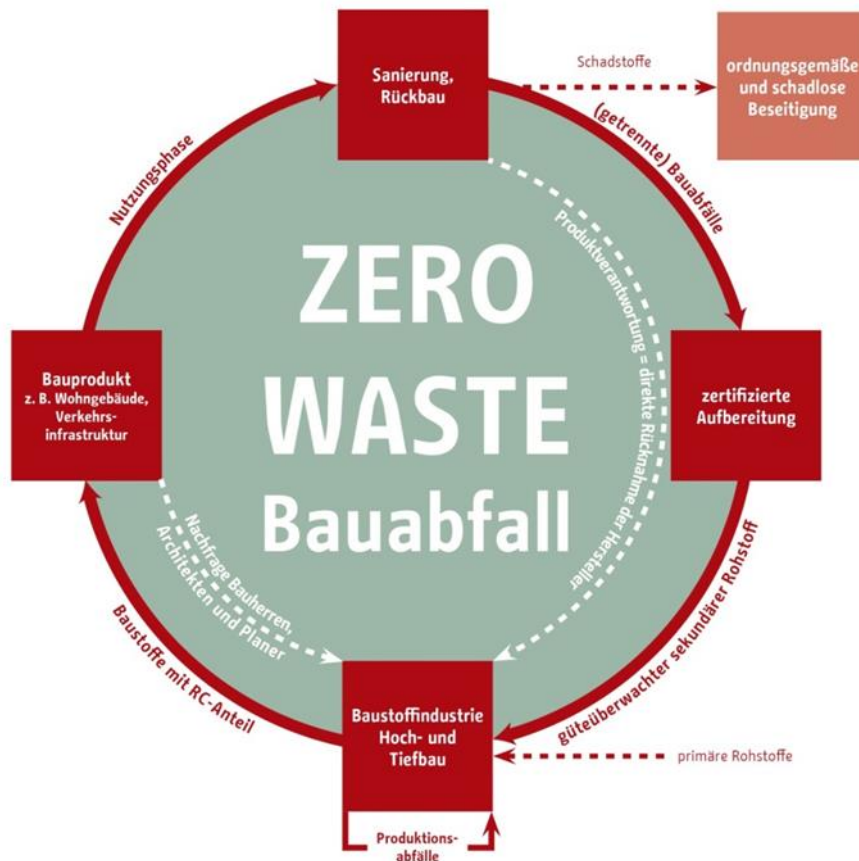
Abb. 5.2: Zero Waste für Bauabfälle (Quelle: ifeu Heidelberg).
