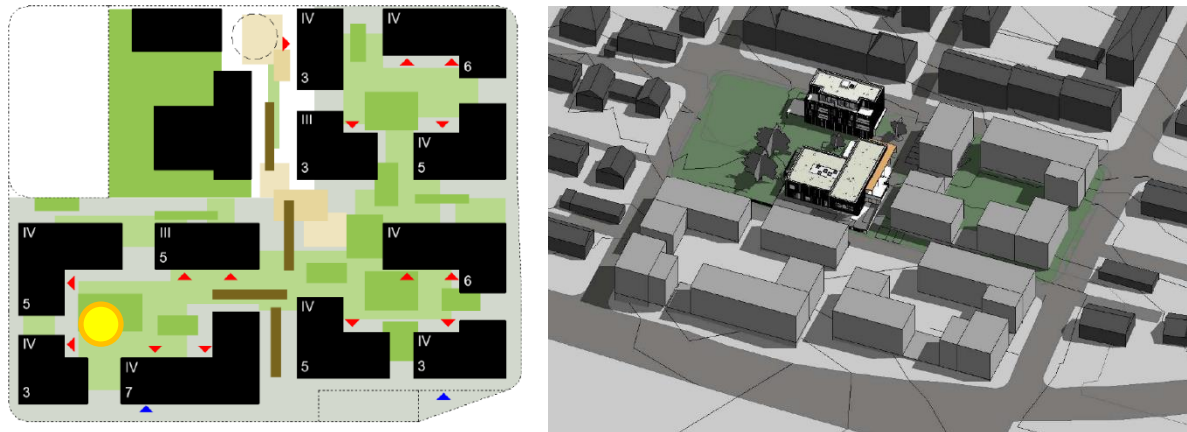
Abb. 6.38: Geplante Variante des Neubaugebiets (links: Grünflächen (dunkelgrün), begehbare Fläche (hellgrün), möglicher Ort für den Speicher (gelb); rechts: 3D-Modell) (Quelle: aag).
