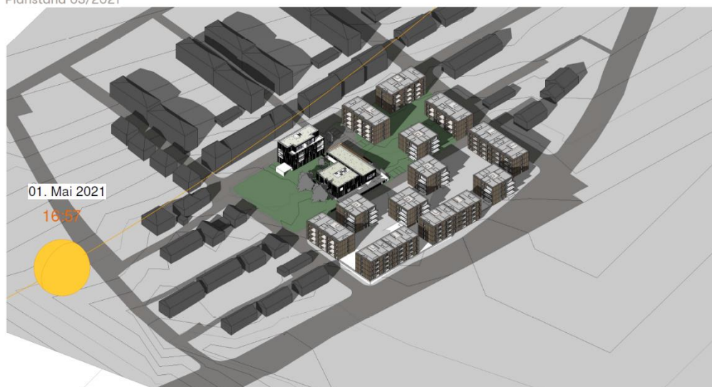
Abb. 7.9: Simulation Sonnenstand im 3D-Modell (Quelle: aag).
